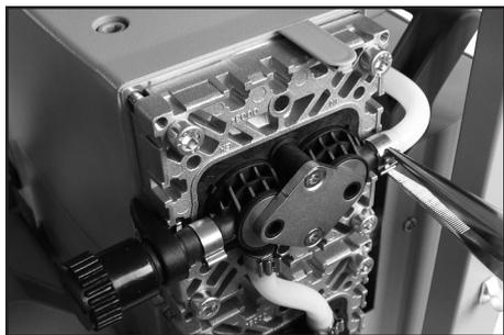
Ripristinare l'attacco del flessibile di collegamento in relazione all'altro lato della pompa.
